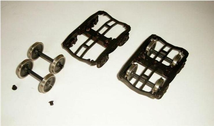
Die Y25 Drehgestelle werden angeschraubt mit M3 Schrauben.
