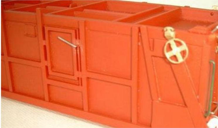
Die Gleit Führungen für das Roll Dach werden in die Splinte montiert, die eingeschoben sind mit Abstandhülse.
