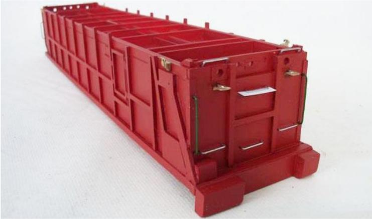
Hinterseite, wobei auch die Splinte eingeklebt werden als Führung Stütze für das Roll Dach.
