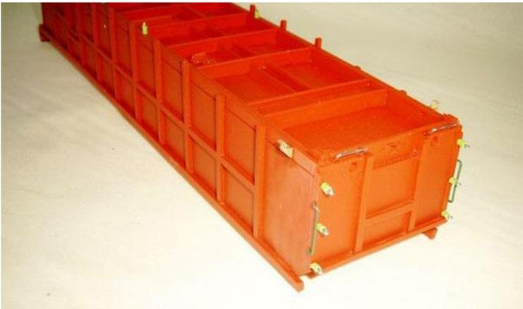
An die Wagenseite werden die Türscharniere, Türgriffe und Handrad montiert.
