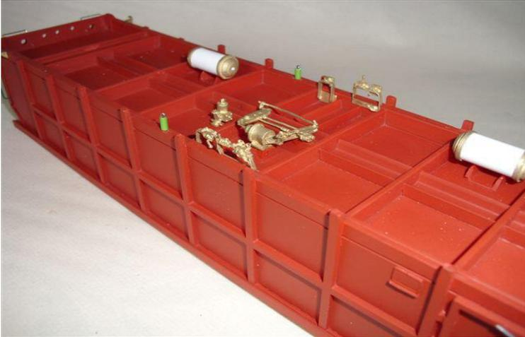
Das Gehäuse wird grundiert.
